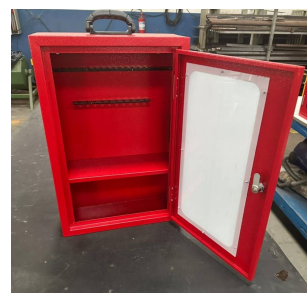
Caixa de Travamento Vermelho Aberto — Vista Interna
